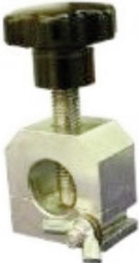
Attrezzo svasatore per tubetto di rame capillare 3x2 per avere poi la perfetta giunzione è tenuta con i raccordi 3x2 filetto M 6x0.75
