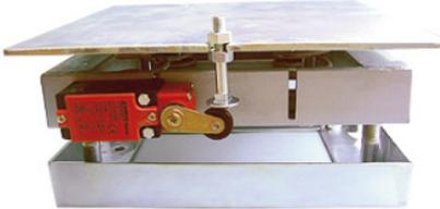
Si monta sotto ogni singola bombola del collettore quando si vuole maggiore sicurezza del peso della bombola, emette un segnale di allarme in caso di perdita accidentale di gas
