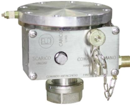
Viene attivato dal termostato pneumatico cod. 713.016.ZA e a sua volta attiva la bombola pilota per la scarica. Non ha bisogno di nessuna fonte energetica.
