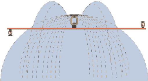
Sono installati all'interno di contro soffitti ed invisibili. La rosetta si adatta a piccole imperfezioni del soffitto e in caso di incendio scende permettendo il flusso a pioggia.
