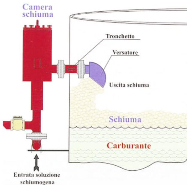
A protezione di serbatoi per liquidi infiammabili a tetto fisso. La schiuma viene erogata all'interno in modo razionale, a bassa velocità, limitando gli spruzzi. Il coperchio removibile per manutenzioni.
